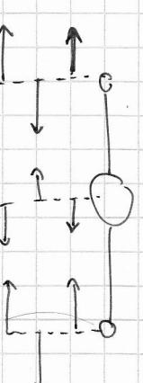
(1) Oscillation harmonique amortie par frottement visqueux
