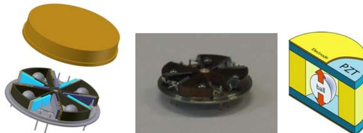
Figure 34. Exemples de micro générateurs récoltant l'énergie vibratoire par un mécanisme de chocs d'une bille sur une structure vibrante piézoélectrique. Dispositifs développés par S.Ballandras à FEMTO-ST.
