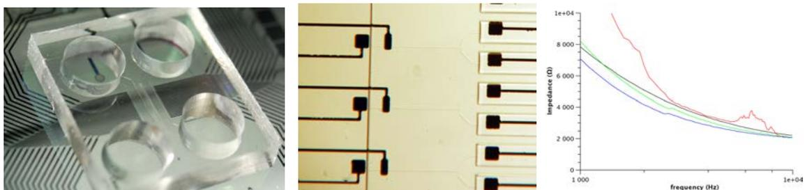
Figure 135. Intégration de micro électrodes en platine dans un circuit microfluidique, image du dispositif montrant l'assemblage du bloc PDMS sur le substrat soutenant les électrodes, image au microscope des électrodes positionnées sous les micro canaux et mesure de l'impédance des électrodes de platine en fonction de la fréquence du signal.
