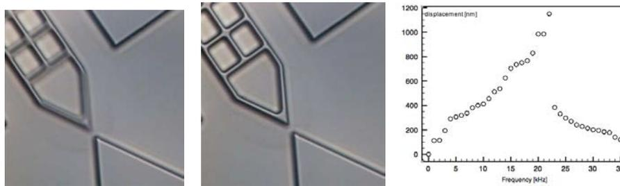
Figure 54. Image à la camera video CCD sur microscope de la résonance de la microstructure et mesure au Laser Doppler des déplacements.
