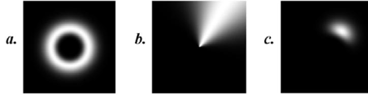
Figure 22. Représentation dans l'espace des fréquences du filtre de Log-Gabor
