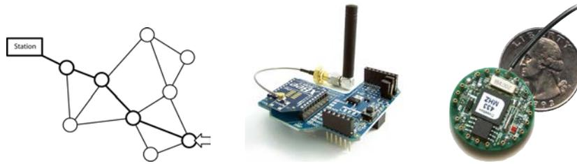
Figure 28. Exemple d'organisation en réseau et de nœuds de ce réseau. Arduino Xbee et Micadot.
