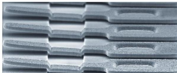
Figure 62. Image SEM des points mémoire à micropoutres développées par la société Cavendish Kinetics.
